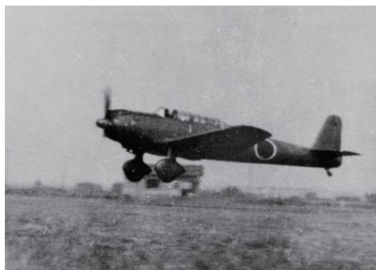
松下飛行機(株)が製作した木製飛行機「明星」
