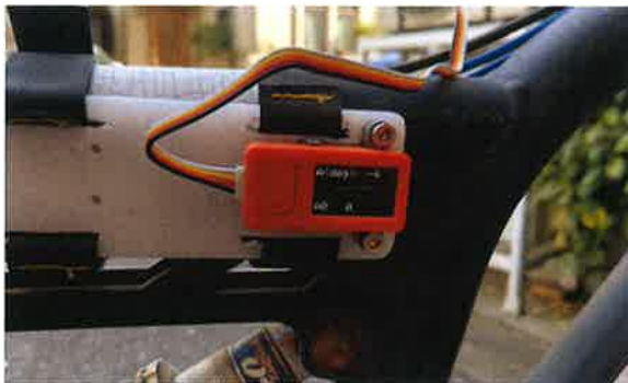
歩行空間の勾配と位置情報を計測するための傾斜角度計（自転車に取り付けて使用）
