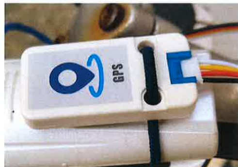
歩行空間の勾配と位置情報を計測するための傾斜角度計（自転車に取り付けて使用）
