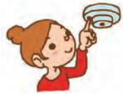
点検ボタンを押すか点検ひもを引っ張り、少なくとも年に2回は作動するか確認してください。反応がなければ、故障か電池切れです。
