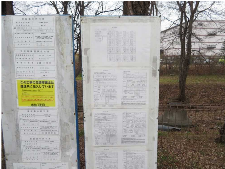
写真4 施工体系図・建設業許可票
