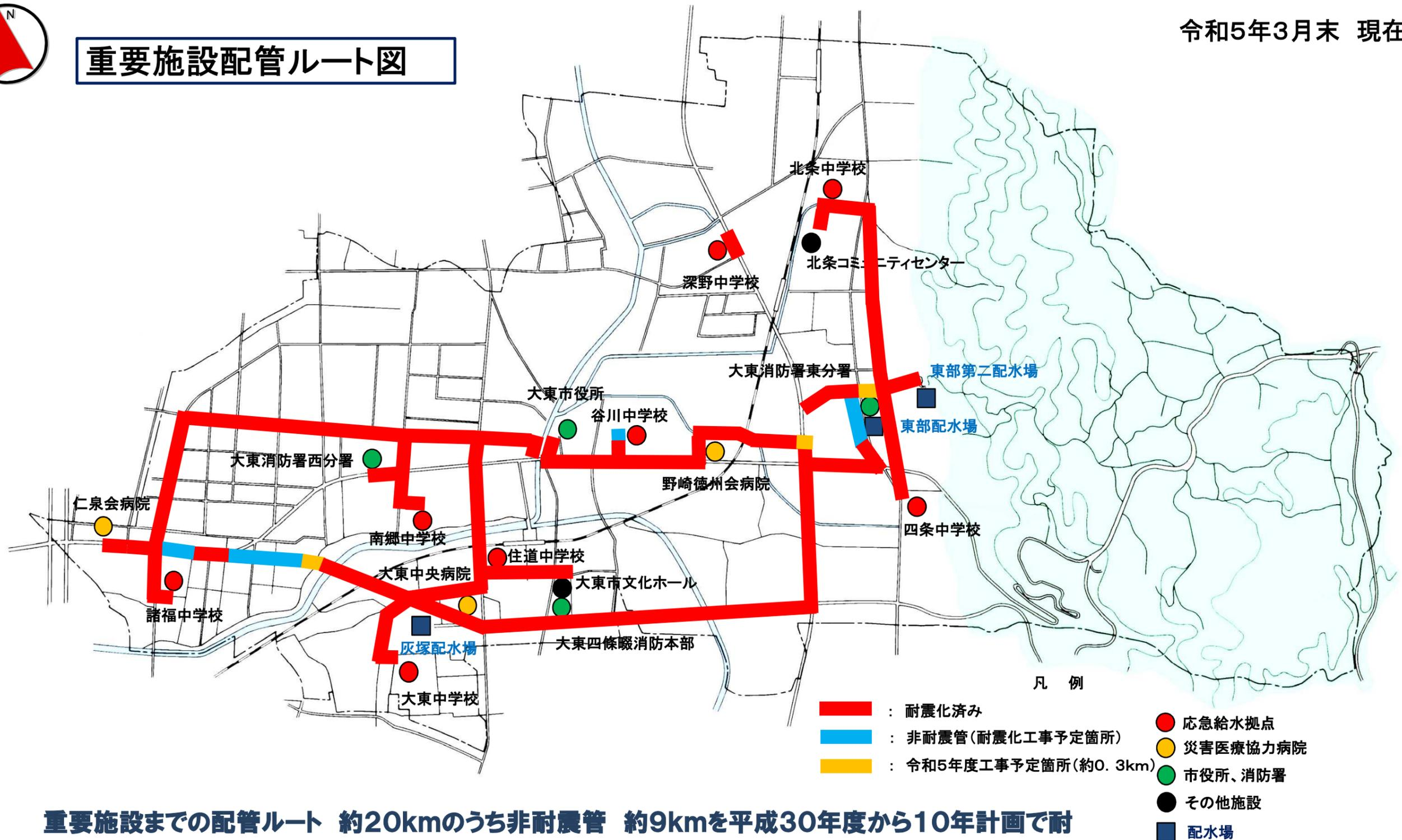
重要施設までの配管ルート 約20kmのうち非耐震管 約9kmを平成30年度から10年計画で耐震化工事を行っております。(令和5年3月末現在、配管ルートの約91%耐震化済み) この工事により災害時においても、重要施設17箇所までの水の確保が可能となります。
