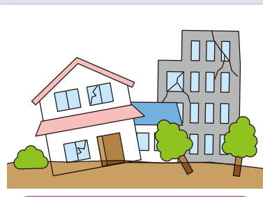
液状化による被害
