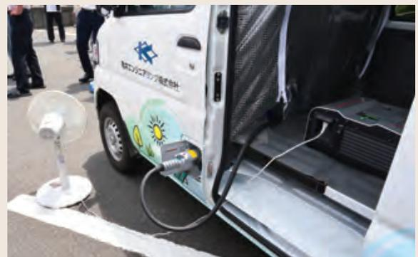
▲電動車両の電源で扇風機が起動
