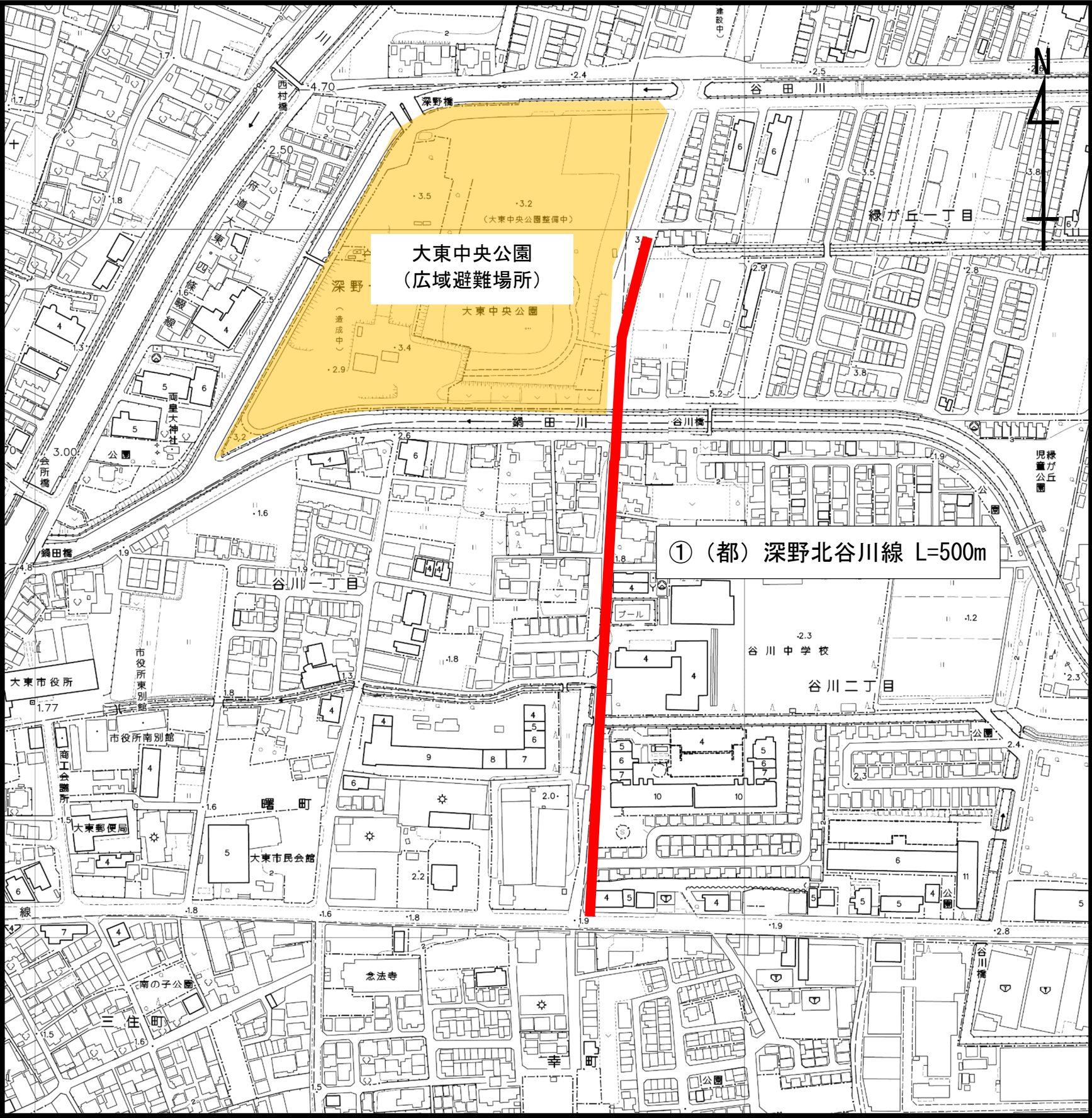
◎無電柱化事業中路線（市道）
